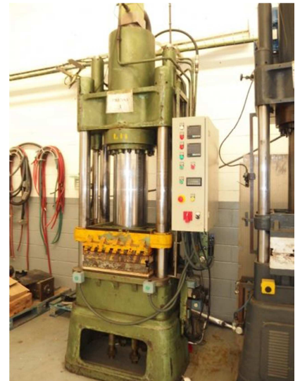
Prensa hidráulica platos calientes 150 ton CAMP 150 Tpc Ref: 17688
