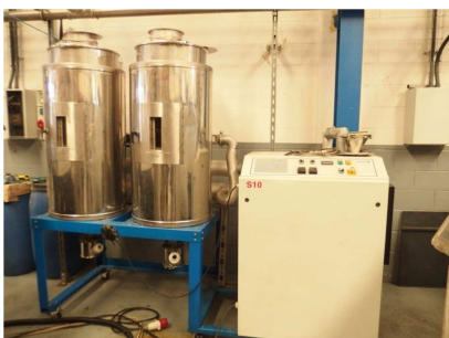
Deshumidificador 160 m3/hora. 400 litros.
